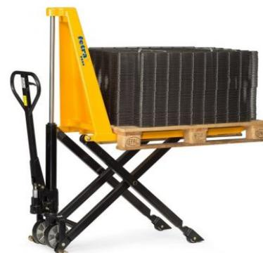
Ce **transpalette à grande levée a été conçu pour lever, descendre des charges lourdes jusqu'à 1000 kg** pour des hauteurs de levée comprises entre 85 et 800 mm.
